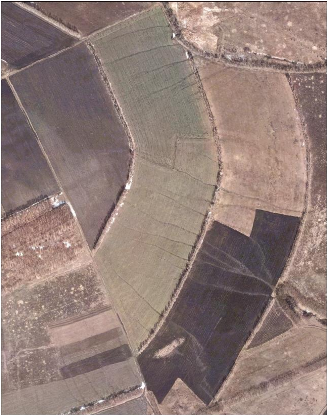
Рис. А.1. Прояв ерозійних процесів (улоговинна ерозія) в системі контурних стокорегулювальних лісових смуг, створених у 1988 р. при впровадженні КМОТ в КСП ім. Кірова Марківського району (Обґрунтування необхідності створення додаткових лісосмуг або чагарникових куліс в міжсмуговому просторі, космічний знімок від 28.02.2009)
