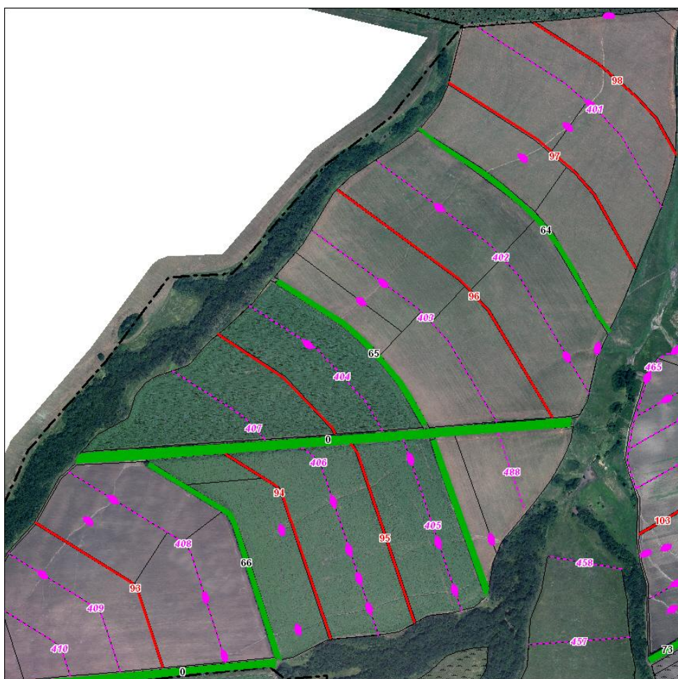
Рис. 4.7. Схема ймовірного розміщення мулофільтрів розсіювального типу на довгому схилі ДГ «Ударник»
