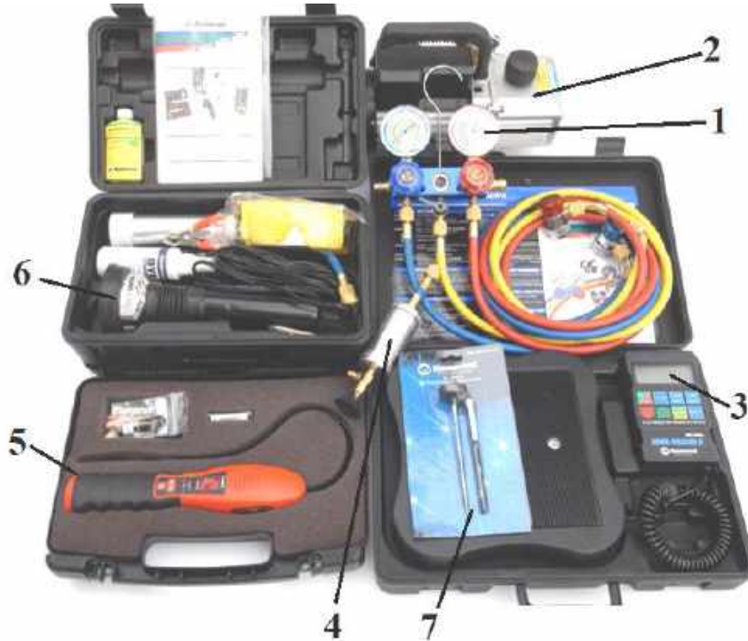
Рисунок 1 – Мінімальний набір приладів для сервісного обслуговування кондиціонерів автомобіля
