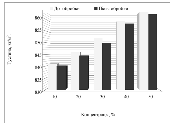
Рисунок 4 – Залежність густини біодизеля від концентрації МЕРО в дизельному паливі до обробки і після обробки ультразвуковими хвилями протягом 5, 10 і 15 хв
