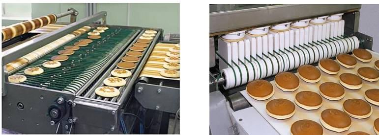
Рис. 4. Дільниця технологічної лінії виробництва кондитерських виробів «ПанКейк» із сирною начинкою (промислове виробництво на ТОВ ПКГ «Лісова казка», м. Харків)
