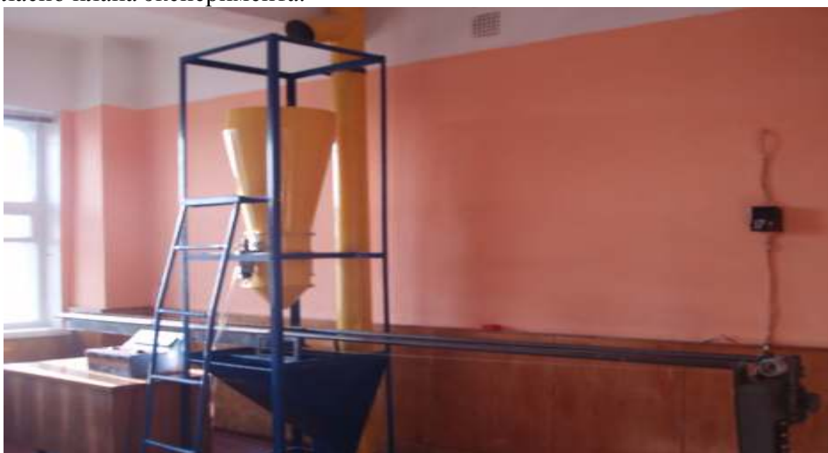
Рисунок 1 - Общий вид установки для исследования процесса смешивания сыпучих кормов
