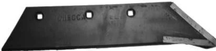
Рисунок 2 – Леміш, відновлений і зміцненим припаюванням пластин
