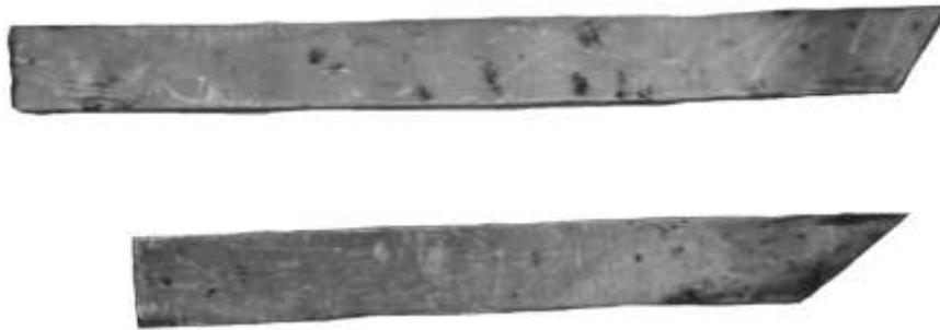
Рисунок 1 – Пластини з термообробленої сталі 130Г7ТЛ підготовлені для пайки
