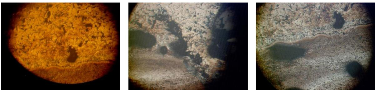
Рисунок 1 – Дефекты, формируемые при наплавке без модифицирующей присадки,  $\times 100$
