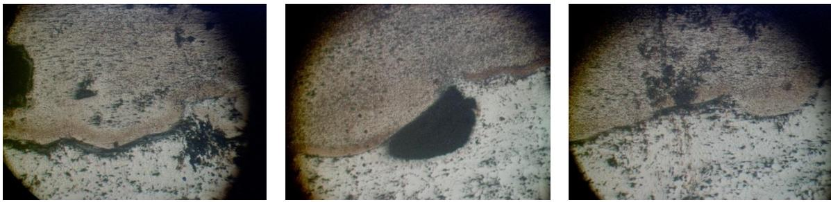
Рисунок 2 – Структура металла зоны наплавки при введении модифицирующей присадки в виде шликерного покрытия,  $\times 100$
