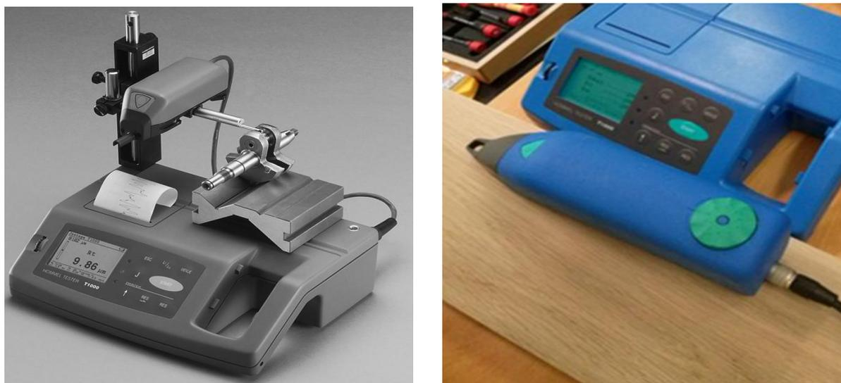
Рис. 3 – Профилограф HOMMEL TESTER T1000 basic
