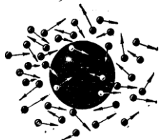
Рис. 6.1 Броунівський рух – це безперервний хаотичний рух твердих часток у рідині (або газу) під дією ударів молекул (рис. 6.1).
