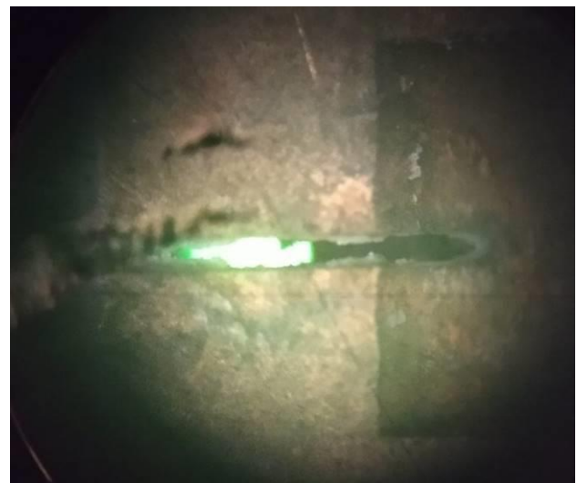
Рис. 1. Сопло щілинного гідравлічного розпилювача після неправильного чищення
