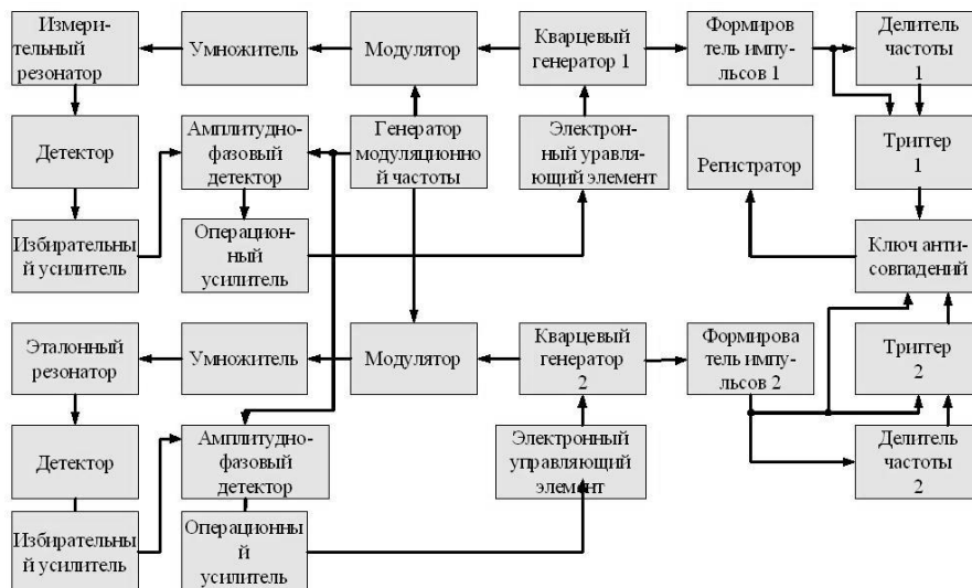
Рисунок 1 – Структурная схема диэлектрической проницаемости воздушной среды с этиленом при хранении яблок
