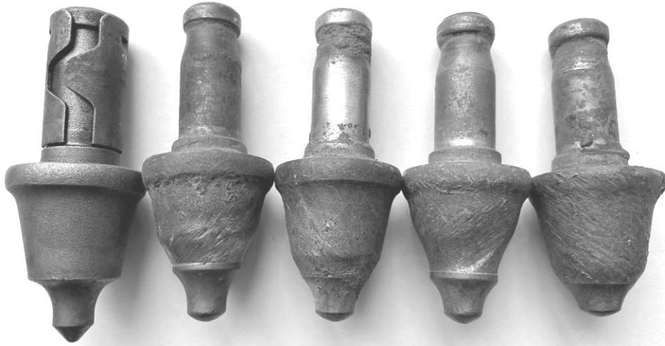
Рисунок 1 – Різці барабанних фрез: а – новий; б-д – зношені
