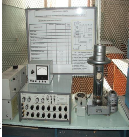
Рис. 1. Установка для визначення коефіцієнта теплопровідності сільськогосподарських матеріалів: 1 – прилад для виміру теплопровідності ІТФ-3; 2 – датчик теплового потоку; 3 – термопари з підложкою; 4 – перемикач; 5 – потенціометр; 6 – декадні перемикачі; 7 – віконця декадних перемикачів; 8 – гальванометр; 9 – термостат; 10 – блок живлення; 11 – холодильник; 12 – зразок (або ячійка); 13 – нагрівач; 14 – індикатор товщини зразка.
