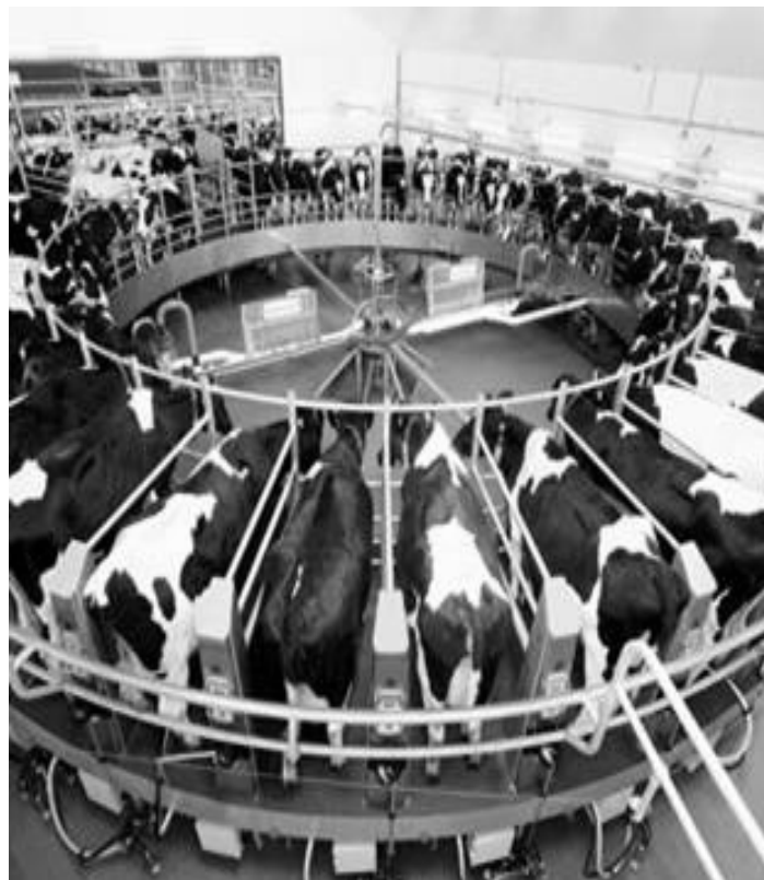
Рисунок 4.6.3 – Доїльна установка типу "Карусель"
