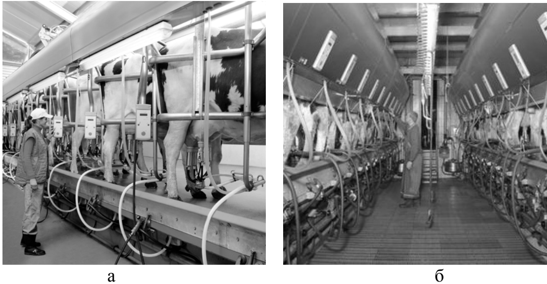
Рисунок 4.6.2 – Доїльні установки типу: а – "Ялинка", б – "Паралель"
