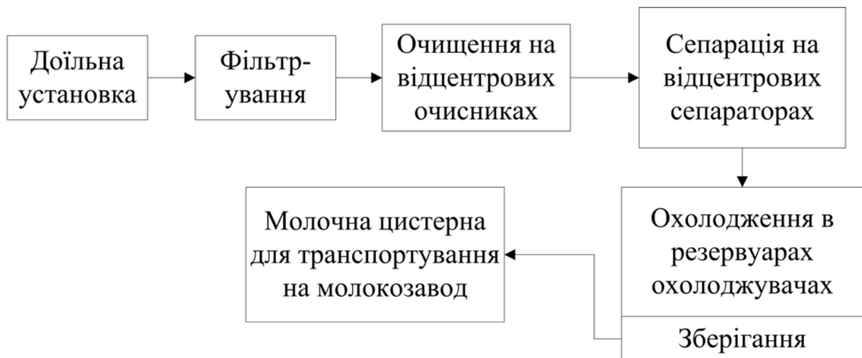
Рисунок 4.7.4 – Технологічна лінія очищення, сепарації і охолодження молока в об'ємних охолоджувачах
