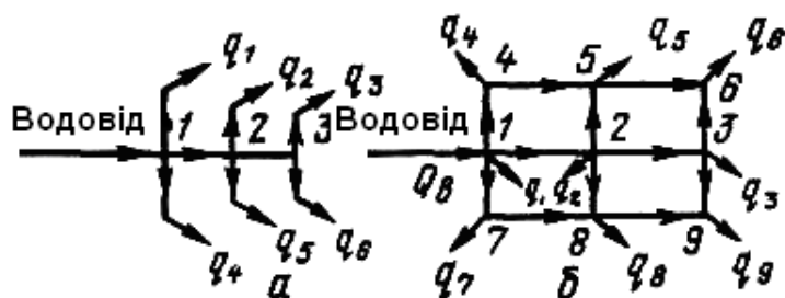
Рисунок 4.5.2 – Схема водопровідних мереж: a – тупикова; б – кільцева.
