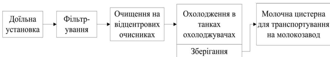
Рисунок 4.7.1 – Технологічна лінія очищення і охолодження молока в об'ємних охолоджувачах
