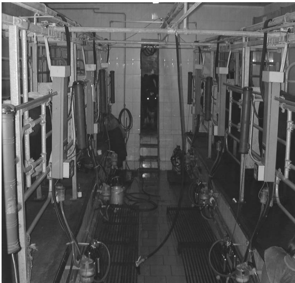
Рисунок 4.6.1 – Доїльна установка типу "Тандем"
