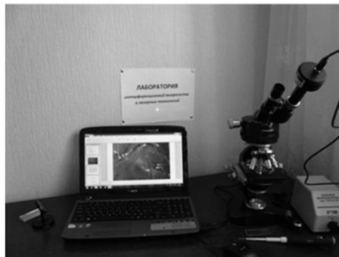
Рисунок 1 – Измерительный комплекс с интерференционно-поляризационным микроскопом MPI-5
