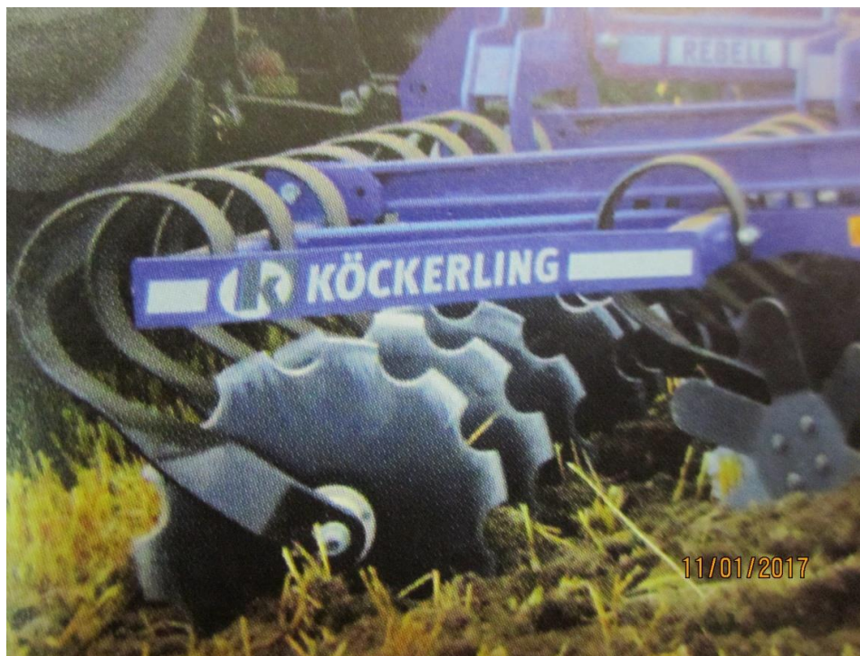
Рис. 6 – Стерновий культиватор «Дельта Flex» фірми Köckerling з кріпленням зубчастих дисків з допомогою пружинних стійок
