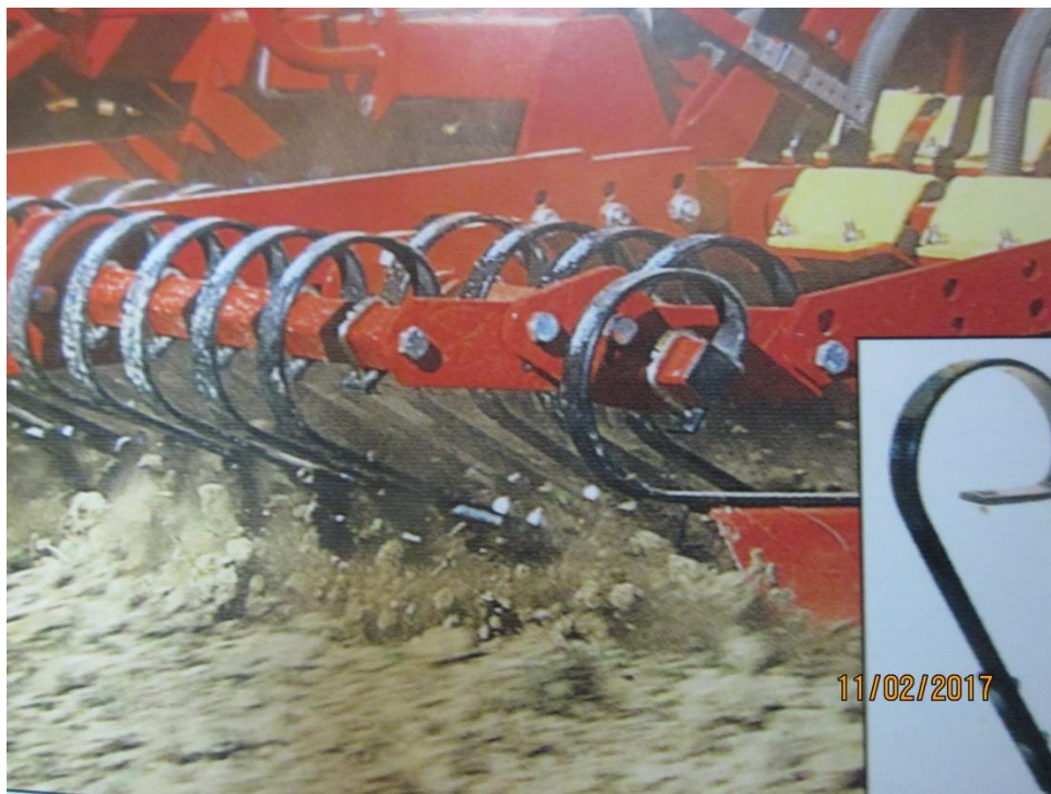
Рис. 4 – Кріплення робочих планок з допомогою пружинних стійок в котку Rexius фірми Väderstad
