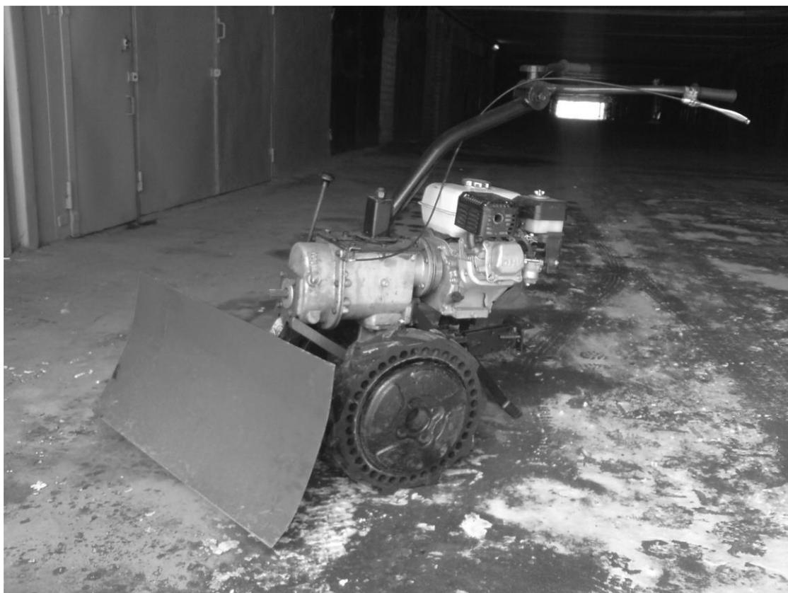
Нашим СКБ в этом году разработан экспериментальный образец снегоуборочного агрегата. Во время испытаний показал надежность конструкции, легкость в эксплуатации и высокую производительность. В сравнении с аналогами имеет низкую цену.
