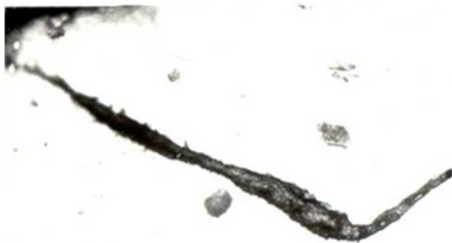
Рисунок 1. Утворення тріщини при випробуваннях на термічну витривалість чавуну з пластинчастим графітом, \times 200
