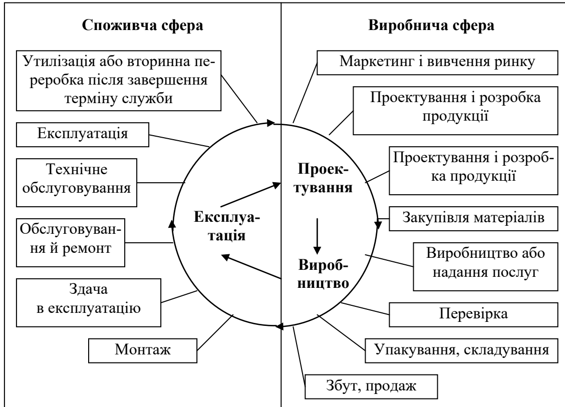
Рис. 2.6 - Модель життєвого циклу продукції (петля якості)
