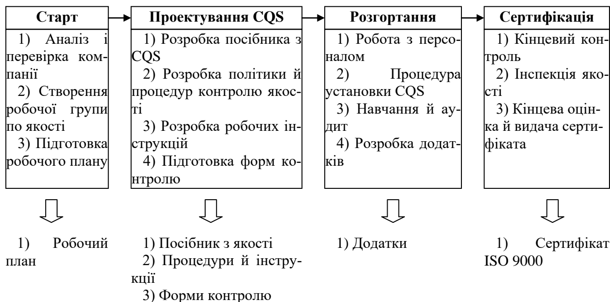
Рис. 2.10 - Схема процесу сертифікації систем якості фірми
