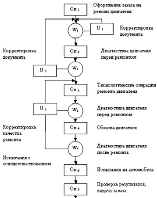
Рис.1 - АФ ТС для капитального ремонта двигателя
