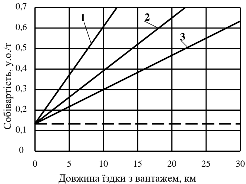
Рис. 7.3 - Залежність собівартості транспортування від зміни довжини їздки з вантажем (1 - ГАЗ-52-04; 2 - ЗИЛ-130; 3 - Камаз-5320)
