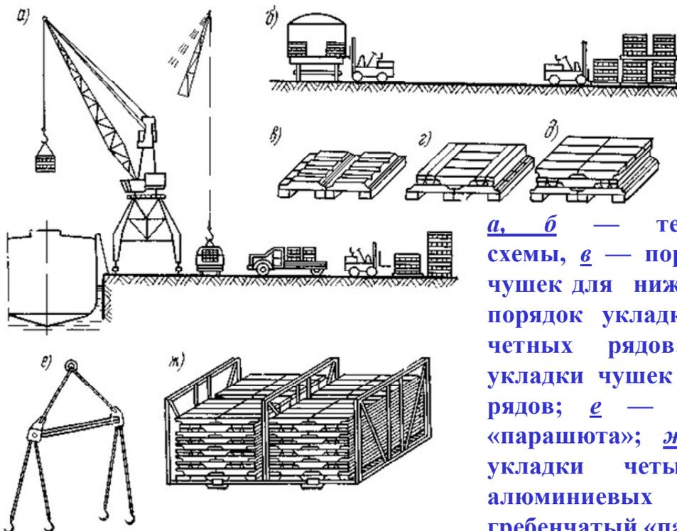
а, б — технологические схемы, в — порядок укладки чушек для нижнего ряда; г — порядок укладки чушек для четных рядов; д — порядок укладки чушек для нечетных рядов; е — подвеска для «парашюта»; ж — порядок укладки четырех пакетов алюминиевых чушек на гребенчатый «парашют»
