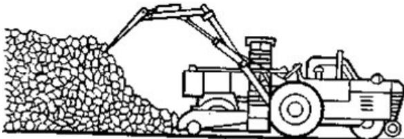
Б) разгрузка буртоукладчиком
