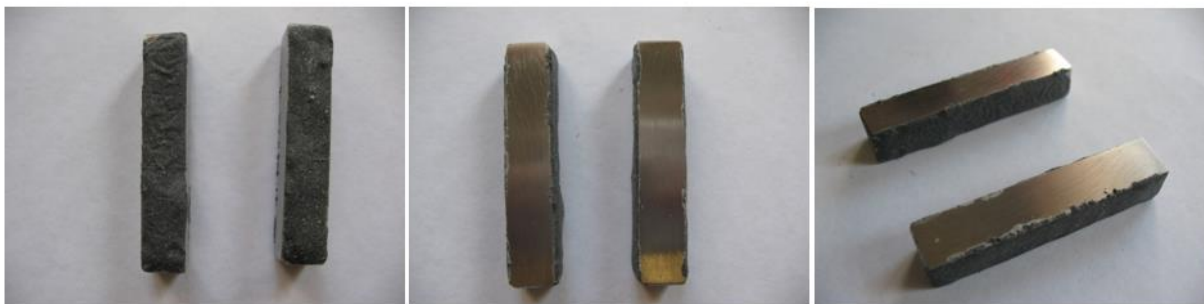
Рис. 1. Зразки на ударний згин після нанесення насичуючої пасту
