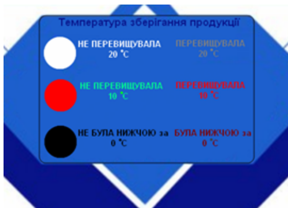
Рис. 2. Термоіндикаторний ярлик для згущеного молока
