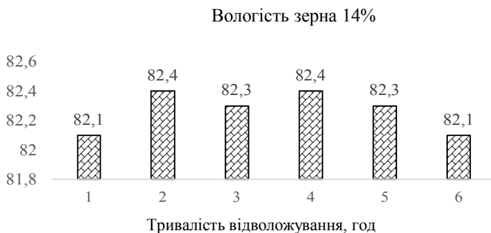
Рис. 1. Вихід борошна із зерна спельти з 13...14-відсотковою вологістю залежно від тривалості відволожування, %: 1 – 5 год; 2 – 10 год; 3 – 15 год; 4 – 20 год; 5 – 25 год; 6 – 30 год
