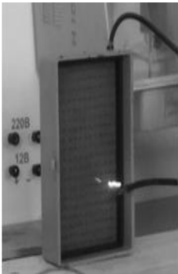
Рисунок 2 – Установка для опромінення насіння ЕЕМП ВН
