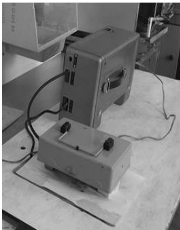
Рисунок 3 – Установка для опромінення насіння ЕЕМП ВФН
