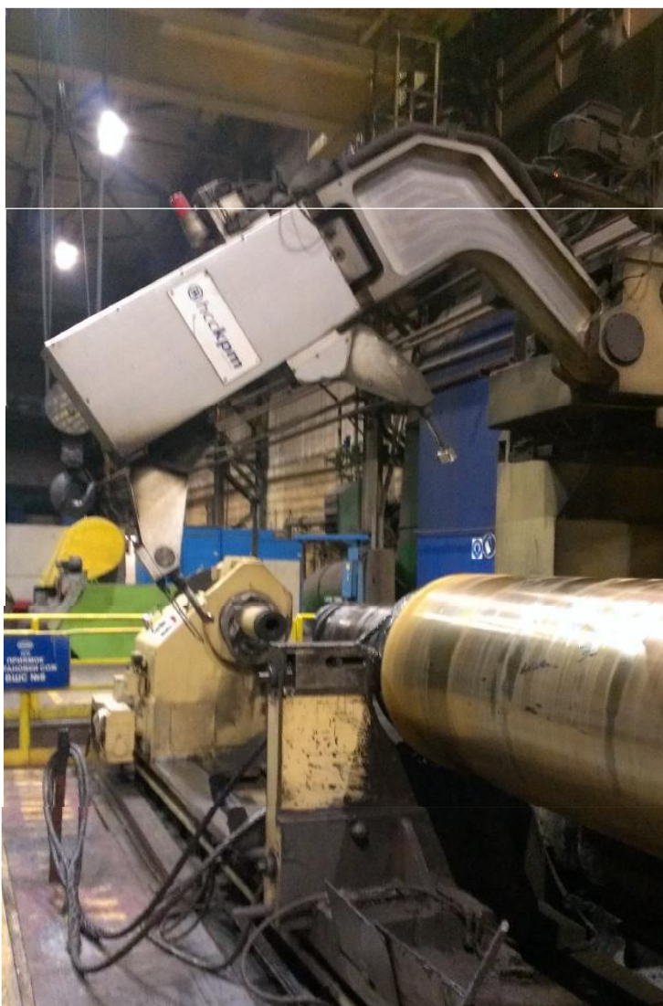
Рис. 1. Пристрій для вимірювань геометричних параметрів прокатних валків
