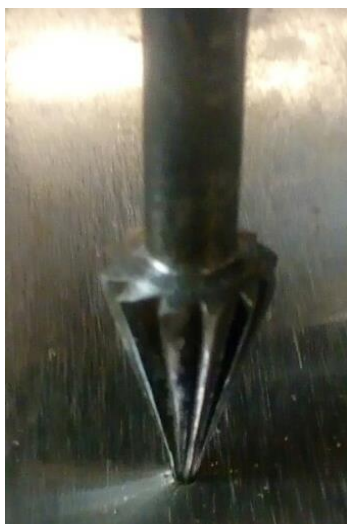
Рис. 4. Нанесення штучної бази на робочу поверхню прокатного валка
