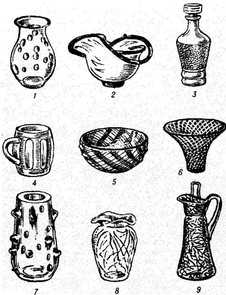
Рисунок 1.17 – Види декорування, що наносять на вивувні скляні вироби в процесі виготовлення: 1 – плями; 2 – бульбашки; 3 – насип; 4 – валикоподібні (хвилеподібні) впадани; 5 – прикраса із застосуванням склотканини; 6 – філігрань; 7 – наліпи; 8 – прикрашання скловолонном; 9 – мороз (кракле).
