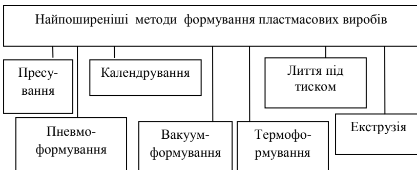
Рисунок 1.7 – Методи формування пластмасових виробів
