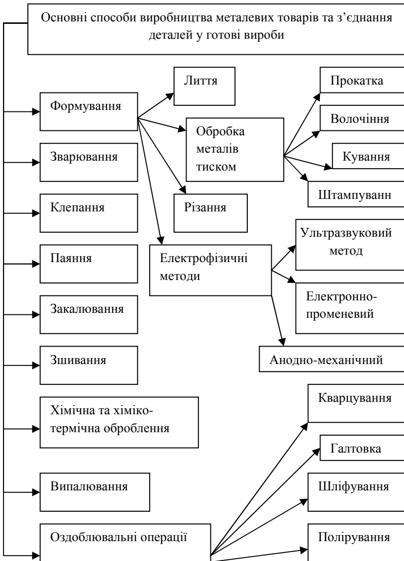
Рисунок 1.57 – Основні способи виробництва металевих товарів
