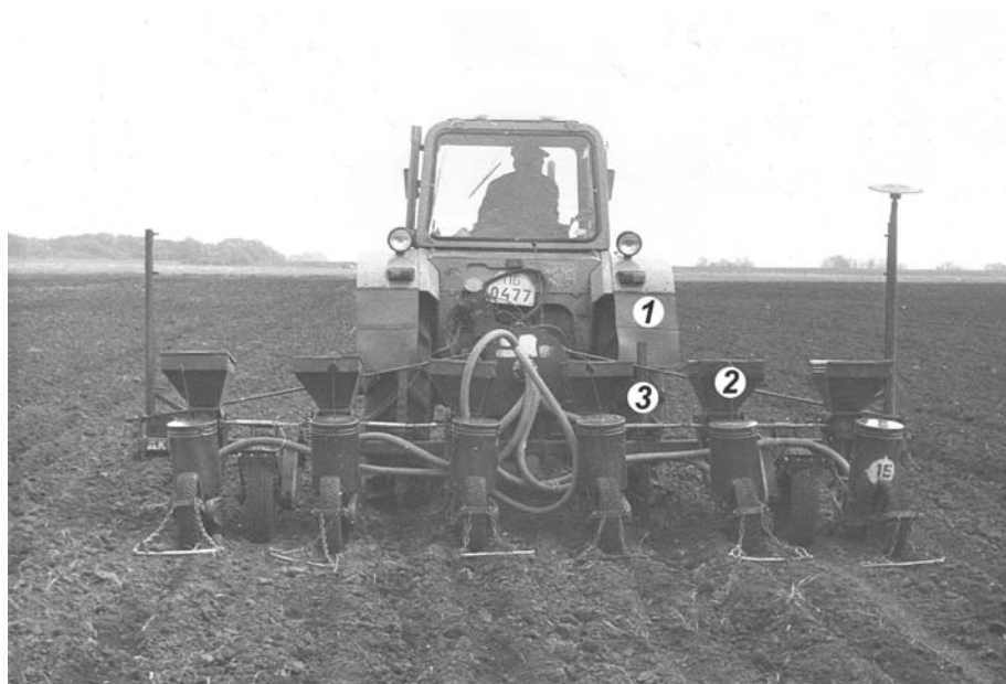
Рис. 6.19. Агрегат для посева кукурузы: 1 — трактор МТЗ-80; 2 — сеялка СПЧ-6ФС; 3 — щелеватель-направитель
