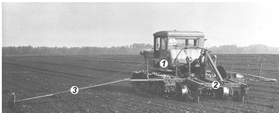
Рис. 6.18. Агрегат для нарезки направляющих щелей в почве: 1 — трактор Т-74; 2 — щелеватель ЩП-00-000; 3 — маркер
