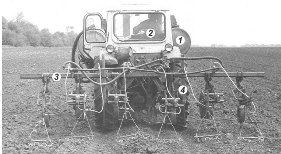
Рис. 6.15. Агрегат для ленточного внутрипочвенного внесения гербицидов: 1 — подкормщик-опрыскиватель ПОМ-630; 2 — трактор ЮМЗ-6АЛ; 3 — культиватор-растениепитатель КРН-4.2; 4 — щелеватель-направитель
