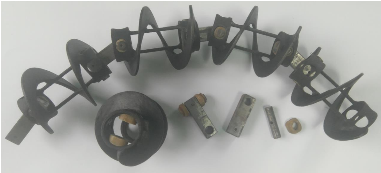
Рисунок 1 – Загальний вигляд секцій робочого органу, розташованого на криволінійній ділянці та його окремих елементів
