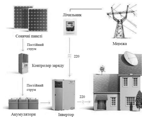
Рисунок 1 - Схема роботи системи Micro Grid
