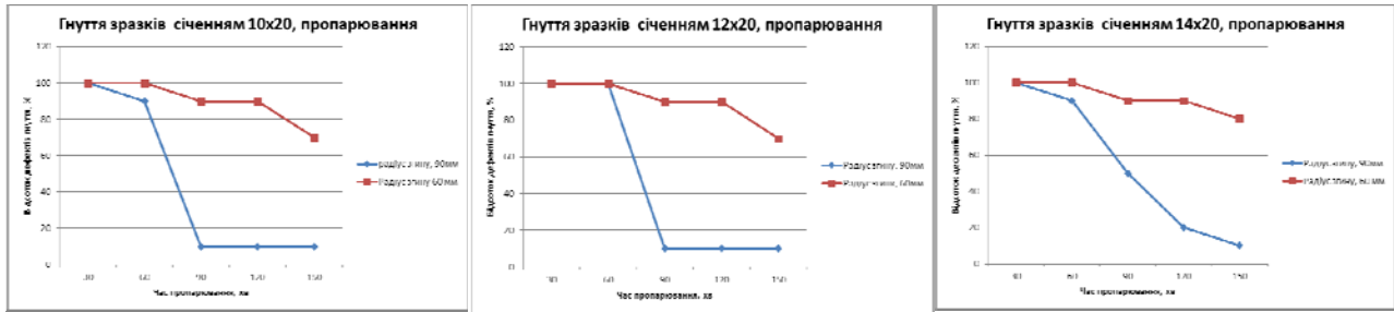
Рисунок 2 – Графічні залежності кількості дефектів при гнутті деревини вільхи, залежно від часу пропарювання для різних радіусів згину
