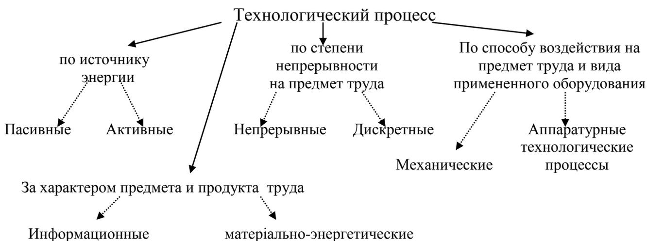
**Рисунок 5 – Технологический процесс**
