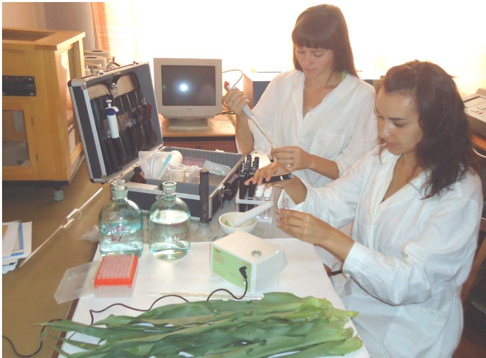
Рис. 2. Визначення забезпеченості рослин макро- і мікроелементами на фотометрі «Агровектор ПФ-014»
