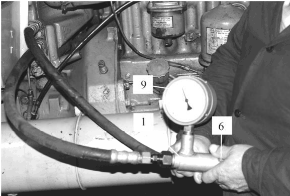
Рисунок 13.15. Підключення дросель-витратоміру KI-1097-1 до гідросистеми
