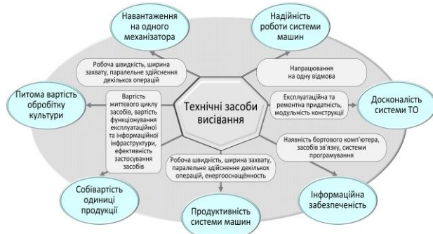
Рис. 7. Вплив характеристик засобів висівання на параметри досконалості системи рослинництва
