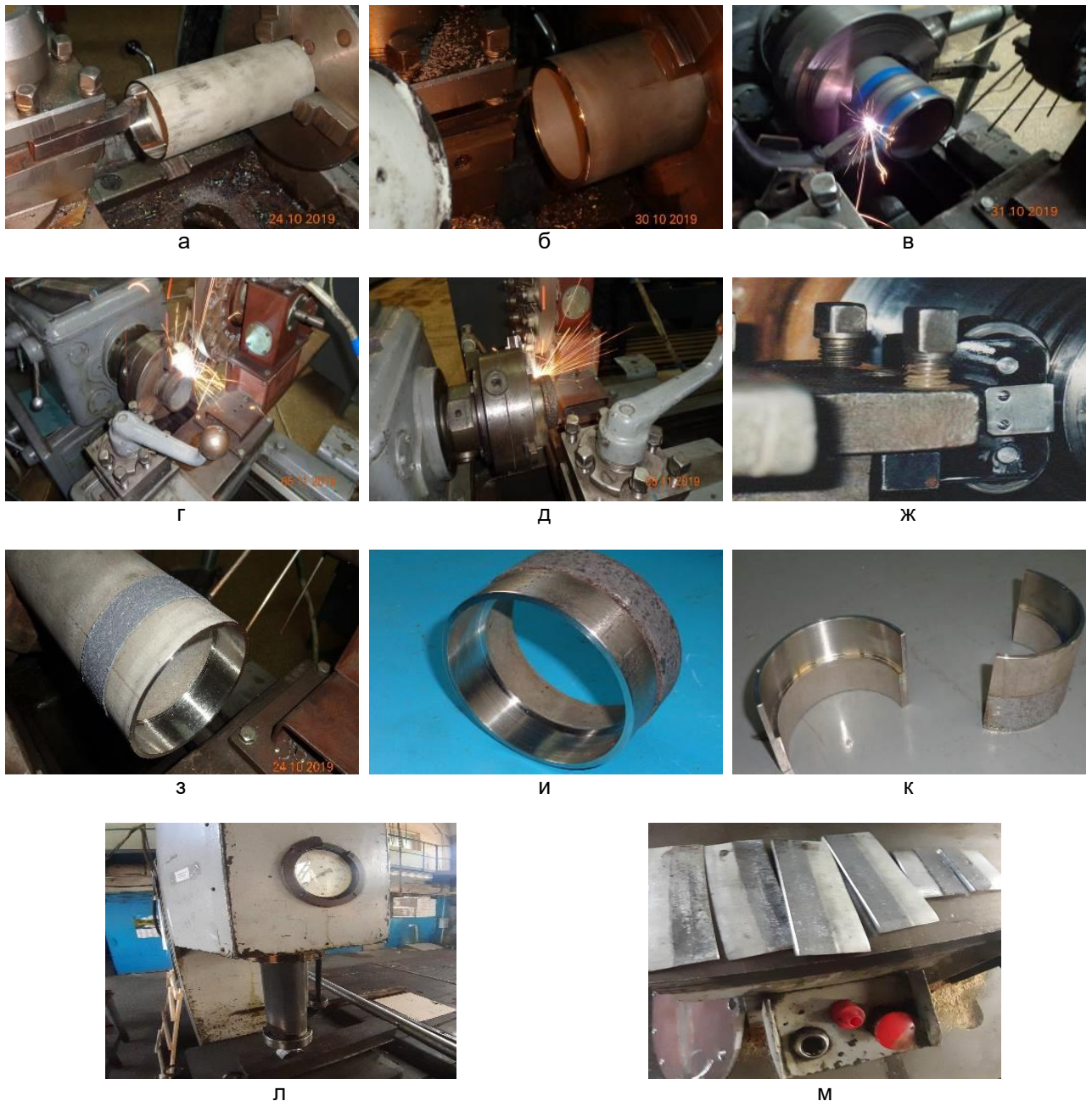
Рис. 6. Послідовність формування товстощарових зносостійких покриттів поверхонь сегментів, призначених для відновлення шнеків
