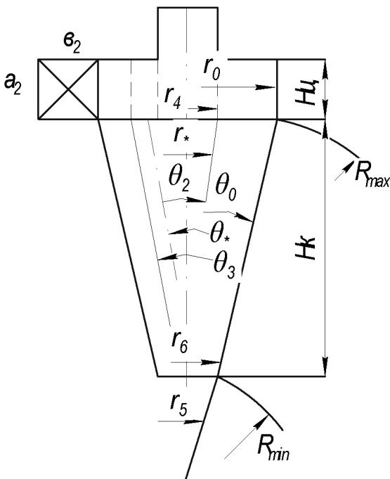
Рисунок – Схема конічного циклона
