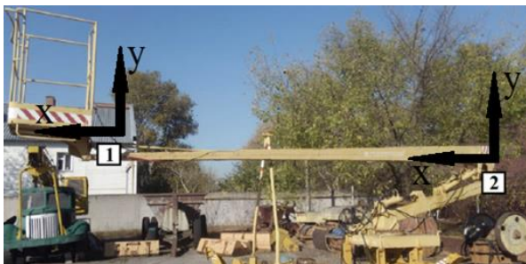
Рис. 4 Точки встановлення двокоординатних акселерометрів
