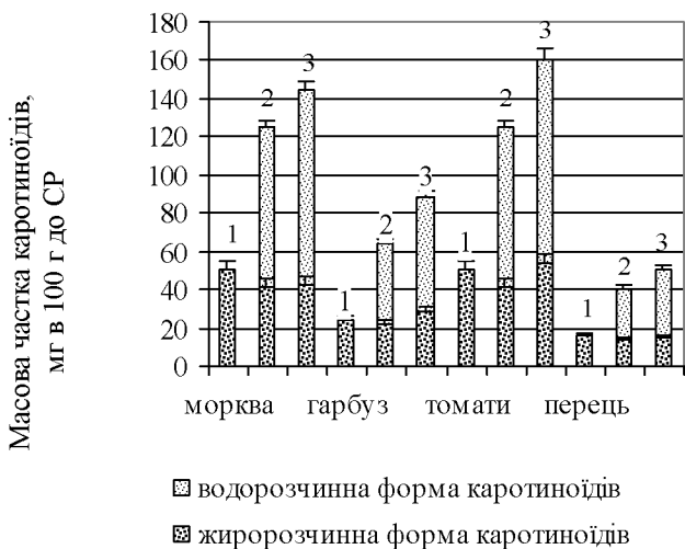
Рисунок 1 – Вплив заморожування на каротиноїди каротиновмісних овочів: 1 - вихідні (свіжі) каротиновмісні овочі (морква, гарбуз, томати, солодкий перець); 2 – КВРС, заморожені з повільною швидкістю в традиційній морозильній камері до температури -18...-20°C; 3 - КВРС «шокового заморожування» зі швидкістю 100°C/хв. до температури мінус 35°C з використанням газоподібного азоту
